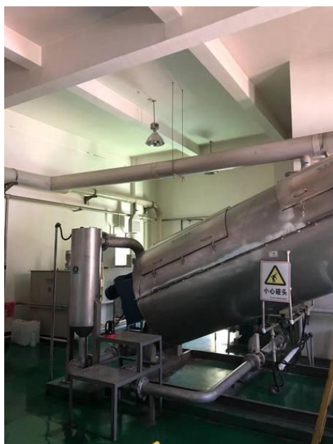
图 5 密闭的处理装置及管道收集
